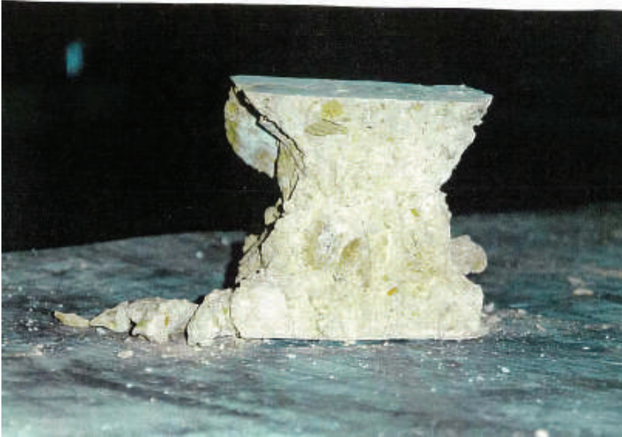
Resim 2.8. Basınç Deneyi Sonrası Numunenin Kırılma Kesiti. Picture 2.8. Cross-Section of Fracture After Compressive Experiment
