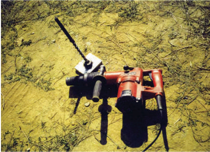
Resim 3.12. HILTI Ve Sıkıştırma İşlemi İçin imal Edilmiş Özel Ucu Picture 3.12. HILTI and Its Special Top Produced for Compression
