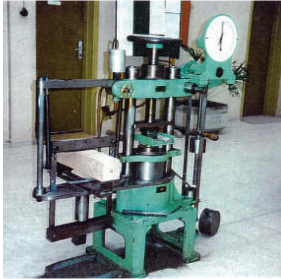
Resim 2.5. Eğilmede Çekme Dayanımı Deneyi Picture 2.5. Bending Tensile Strength Experiment
