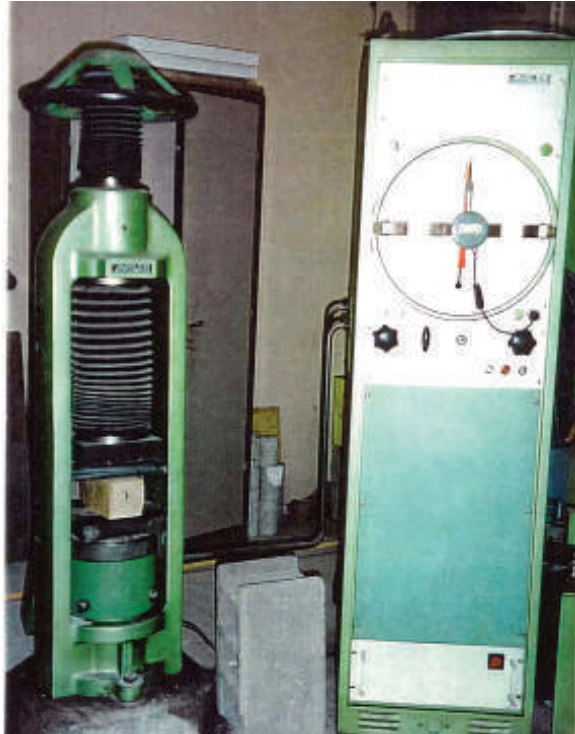
Resim 2.6. Basınç Dayanımı Deneyi Picture 2.6. Compressive Strength Experiment
