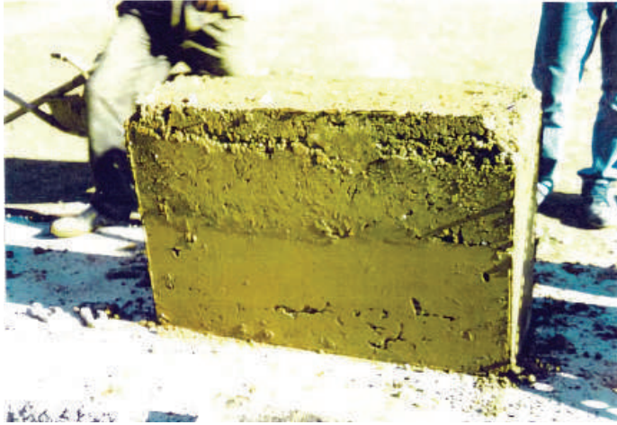
Resim 3.20. Bir Numune Üzerinde Farklı Zamanlarda Uygulanan Vibrasyon Sonucu Picture 3.20. The Result of Vibration Applied on A Sample in Different Times
