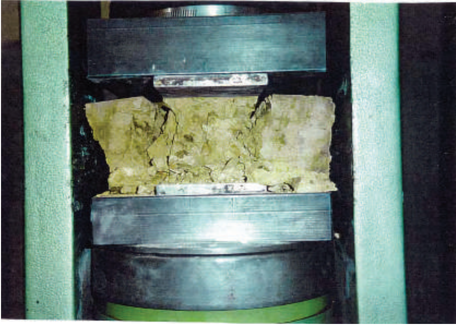
Resim 2.7. Basınç Presindeki Numune Picture 2.7. The Sample in Compressive Press
