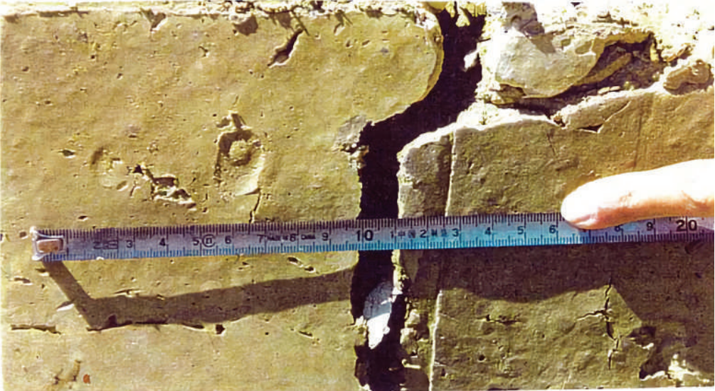
Resim 3.6. Likit Kıvamdaki Karışımın Rötire Çatlağı Picture 3.6. Shrinkage Fracture of the Mixture in Liquid Consistency
