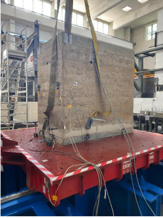
Şekil 2.3. LSM1 sarma masası deney numunesi.
