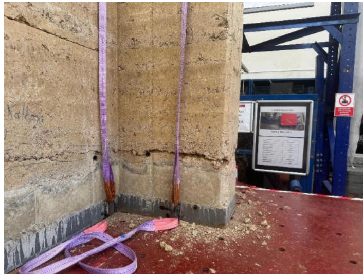
Şekil 3.4. LSM2'nin 2.00×D2 sırasında maruz kaldığı ayrılma hareketi.
