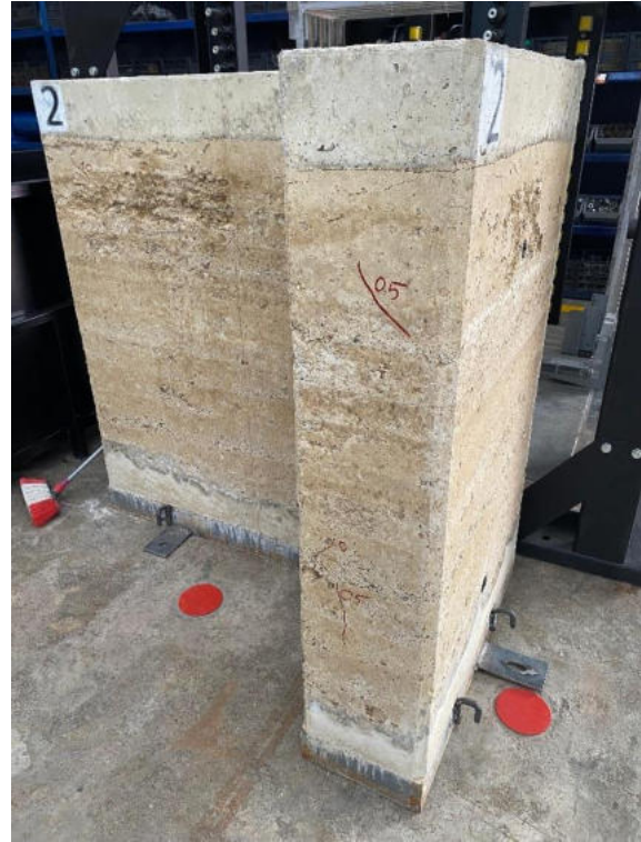
Şekil 3.3. LSM2'nin deney sonundaki çatlak gelişim ve yapısal hasar durumu.
