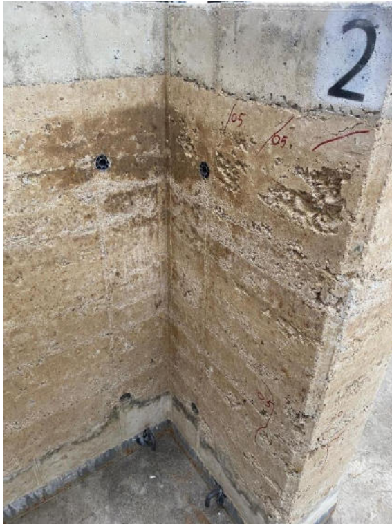
Şekil 3.3. LSM2'nin deney sonundaki çatlak gelişim ve yapısal hasar durumu.
