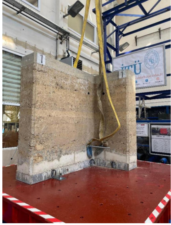
Şekil 2.3. LSM1 sarma masası deney numunesi.
