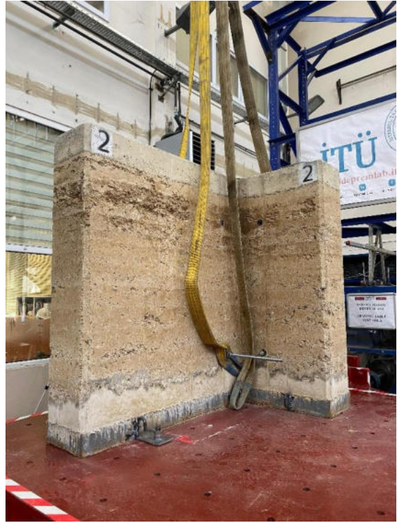
Şekil 2.4. LSM2 sarma masası deney numunesi.
