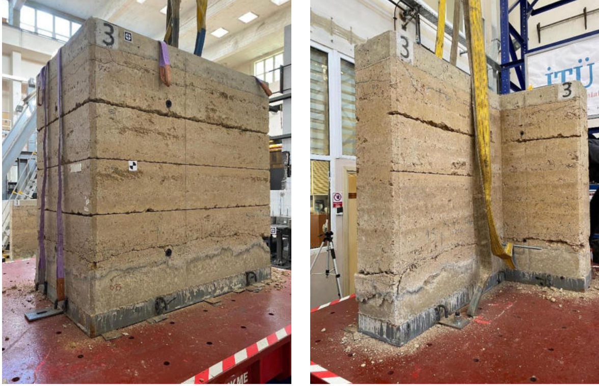
Şekil 3.3. LSM3'ün deney sonundaki çatlak gelişim ve yapısal hasar durumu.
