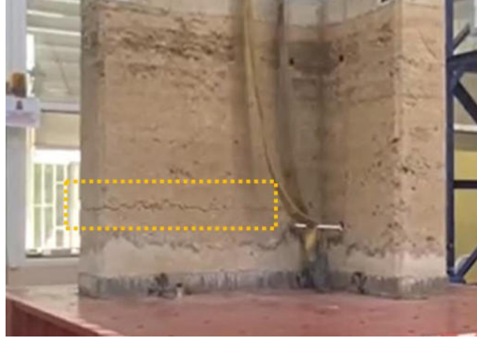
Şekil 3.2. LSM2'nin 2.00×D2 sırasında maruz kaldığı ayrılma hareketi.
