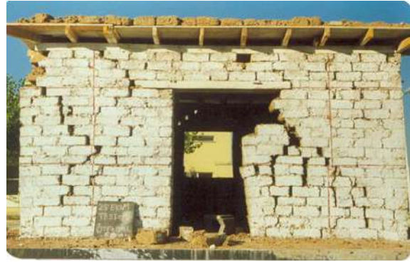
(R.23) Alçılı kerpiç yığma+ shotcrete + yatay esnek (R.24) Eşit mukavemetli geleneksel örgü
