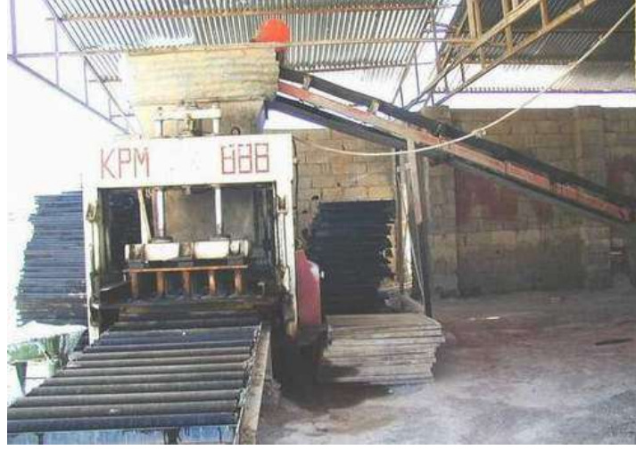
Resim 7.4. URFA' da Pilot Yapı İnşaatı İçin Alker Blok İmalatı, Ekim 1999
