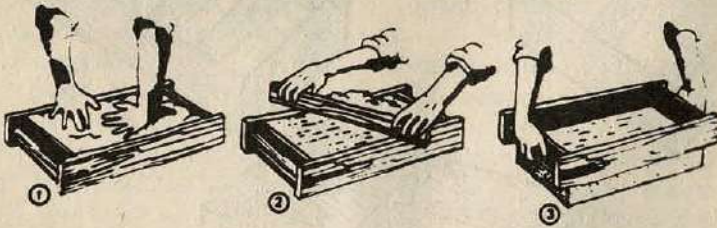
Şekil 7 : Kerpiğin kalıba yerleştirilmesi, yüzeyinin düzeltilmesi ve kalıptan çıkarılması.
